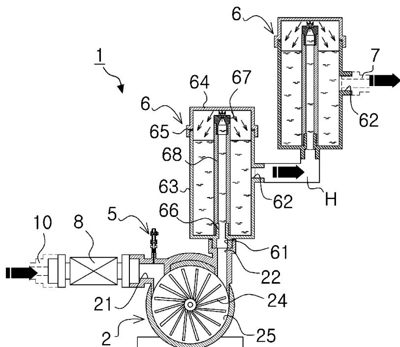
전원공급부의 전원을 제어수단의 제어를 통해 공급받아 발생되는 모터의 회전력을 통해 혼합수를 펌프하도록 된 임펠러가 배치되는 펌프실을 가지는 펌프와; 상기 펌프의 유입구에 접속하여 외부에서 공기를 상기 유입구로 공급하도록 된 공기공급수단;을 포함하여 이루어지는 나노버블발생장치에 있어서; 상기 펌프의 배출구에 관접속되어 상기 배출구를 통해 펌프되어 강제로 이송압력을 가지는 물과 공기가 혼합된 혼합수를 공급받도록 된 공급구와, 상기 공급구를 통해 공급받은 혼합수를 외부로 토출하는 토출구와, 상기 공급구와 상기 토출구의 사이공간에 외부에 대하여 밀폐되어 물에 대한 기체의 용해압력을 형성하도록 된 용해공간을 가지는 용해조;를 더 포함하여 이루어지는 나노버블발생장치를 제공한다.
